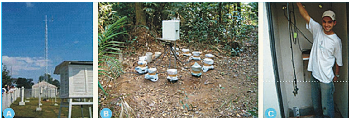
Figura 17 | Cercado da Estação Meteorológica com o abrigo meteorológico no primeiro plano, pluviômetros no segundo plano e torre metálica da Estação Meteorológica Automática ao fundo (A); rede de sensores de umidade de solo (B); e sensor de nível do lago do PEFI (C) instalados no Parque CienTec.
